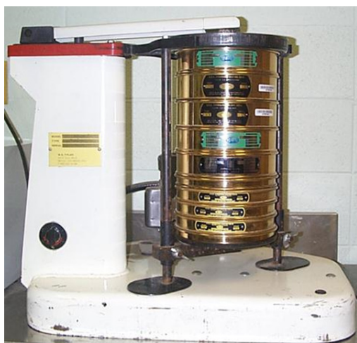
Figura 03 – Equipamento Ro - Tap.
