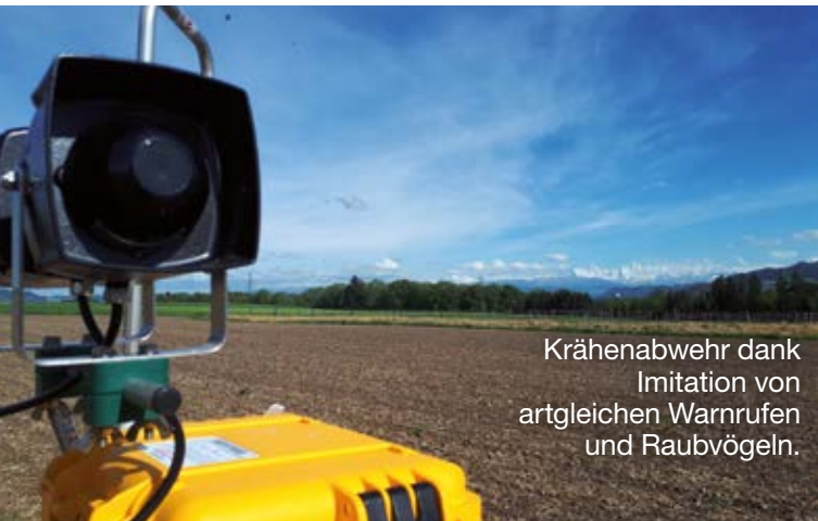
BirdAlert Hardware in wetterfester Transportbox. Steuerung und Überwachung des Systems via Smartphone.
