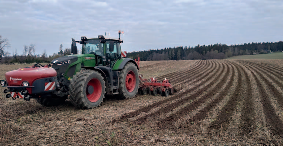
Pro technologii strip-till využívá podnik vlastní stroj Kverneland Kultistrip s čelním zásobníkem na kapalná hnojiva
