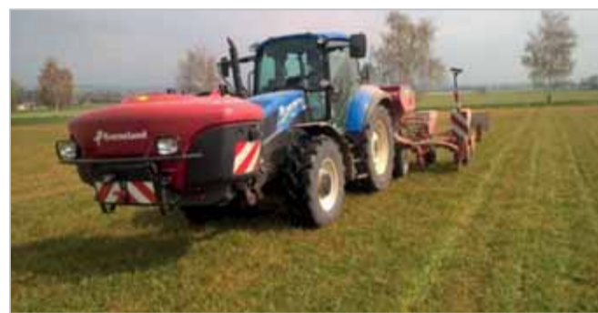
Obr. 2 - Souprava secího stroje a čelně nesené nádrže pro aplikaci kapalných látek při výsevu kukuřice seté se souběžnou pásovou aplikací herbicidu Foto Jirůň Šmóger
